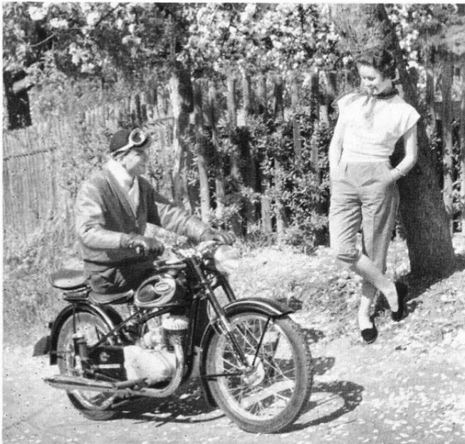
BDG 125: robust, zuverlässig, absolut soziesfest, hoher Fahrkomfort, Doppelkolbenmotor, 6,4 PS, 93 km/h. Ein Motorrad, wie es sein soll.
